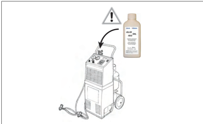
Fig. 15 Añada la cantidad adecuada de lubricante
