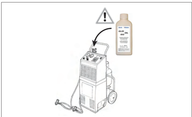
Abb. 15 Korrekte Schmiermittelmenge zugeben
